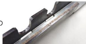
▲製品の切断面のみに発生したサビ
