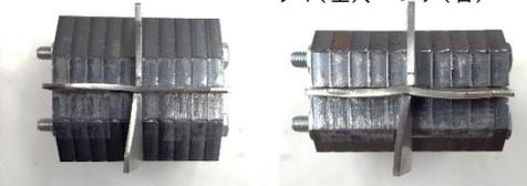
▲変形・破損してしまった積層金型。ダイ(左)、パンチ(右)
