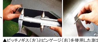
▲ピッチノギス(左)とピンゲージ(右)を使用した測定
