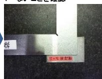
▲マスターとのズレや隙間がないことを確認
