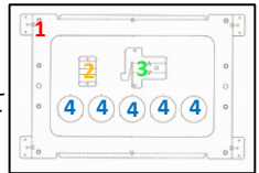
1シートで4種の部品を抜き取る▲
