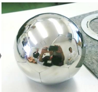
▲治具を使用し、半球を2つ作る。その2つを合わせて、溶接すると・・・
