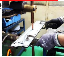
▲スポット溶接の様子
